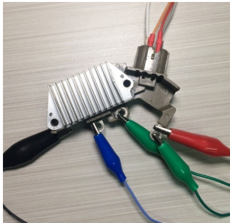
Рисунок 14. Регулятор ARE6076, під'єднаний до виводів тестера
