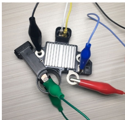
Rysunek 12. Podłączenie regulatora ARE1054 do testera
